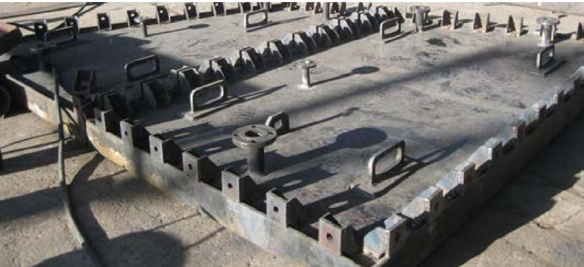
FABRICACION DE PANELES Y MARCOS PARA CAMPANA DE ENFRIAMIENTO DE GASES DE CONVERTIDORES + BOCA DE HORNO PARA FUNDICIÓN
