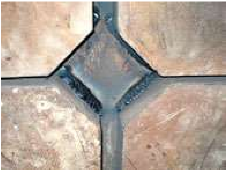
AREA DE CHANCADO CAMBIO DE LINNERS EN LOS OCTOGONALES DE CHANCADO PRIMARIO
